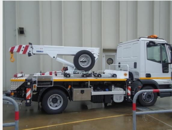
L'équipement peut être installé sur des véhicules de 5 à 12 tonnes de PTAC. Pour une stabilité suprême dans une variété de situations, les M15/M30 sont équipés d'un système de stabilisation hydraulique qui comprend des stabilisateurs hydrauliques avant conçus pour la stabilité, le levage et l'ancrage de votre unité pendant ces récupérations difficiles.
